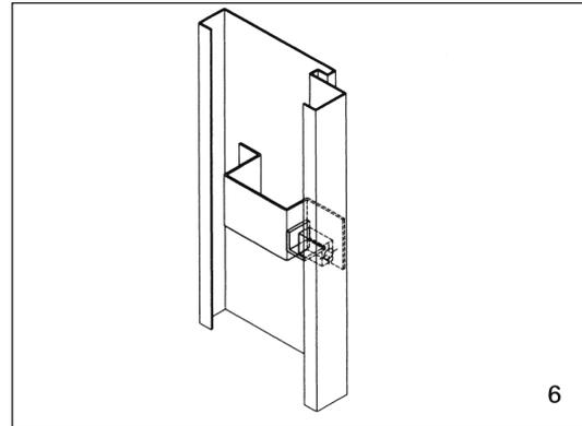
Bei schweren Türen (Doppelfalz, Spital, Blei, Schusshemmung usw.) sowie bei Türen ab 1000 mm lichter Breite sind an den Zargen situativ zusätzliche Verstärkungen vorzusehen (z. B. Erhöhung der Materialstärken bei Zarge und Bügel/Laschen, zusätzliche Laschen auch beim oberen und allenfalls beim 3. Band, Aussteifungen usw.).
