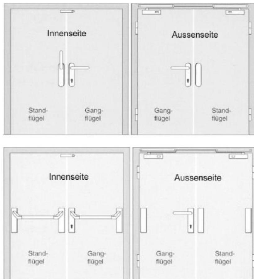
Hat der Standflügel ebenfalls Fluchtwegfunktion, muss ein Panik-Treibriegelschloss verwendet werden. Dabei wird nach SN EN 179 der Drücker am Standflügel senkrecht angebracht. Auf diese Weise sieht der Benutzer, welches der Gehflügel ist.
